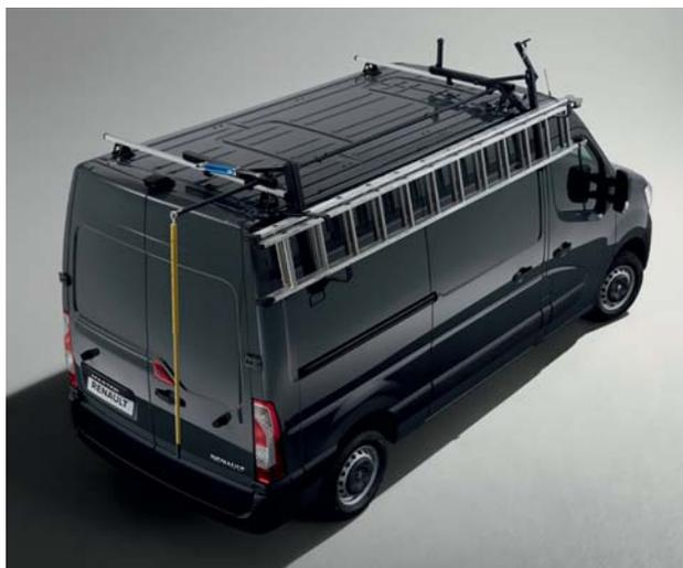
Le porte-échelle rotatif ErgoRack vous permet de transporter et de manipuler tous les types d'échelle sans effort. Facile à installer grâce à sa compatibilité avec les barres de toit Renault Trucks.
