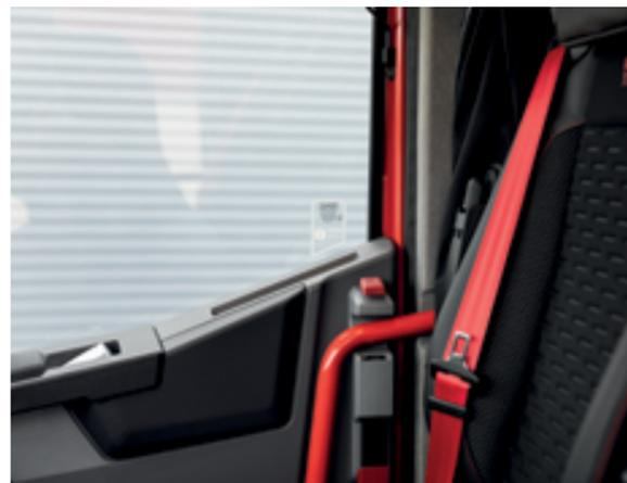
Verrouillage mécanique anti-intrusion Doorlock 74 84 078 457
